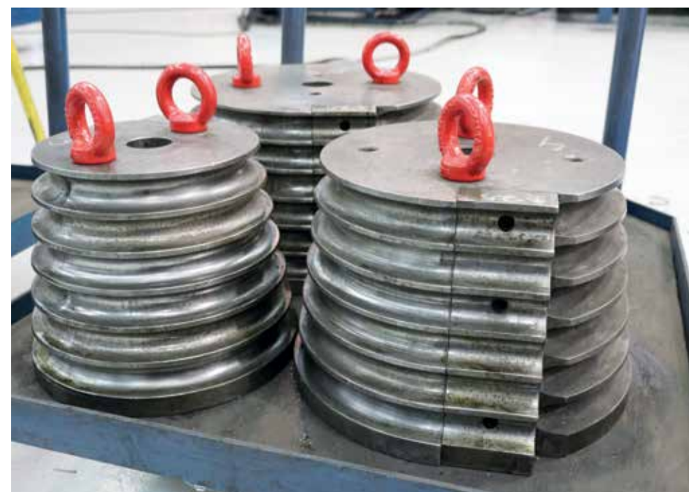
Eigen ontworpen en vervaardigd gereedschap voor buigwerk.
