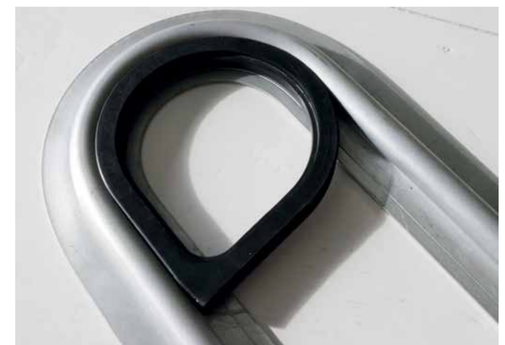
Met een eigen ontworpen kunststoffen ring wordt het aluminium profiel correct gebogen.
