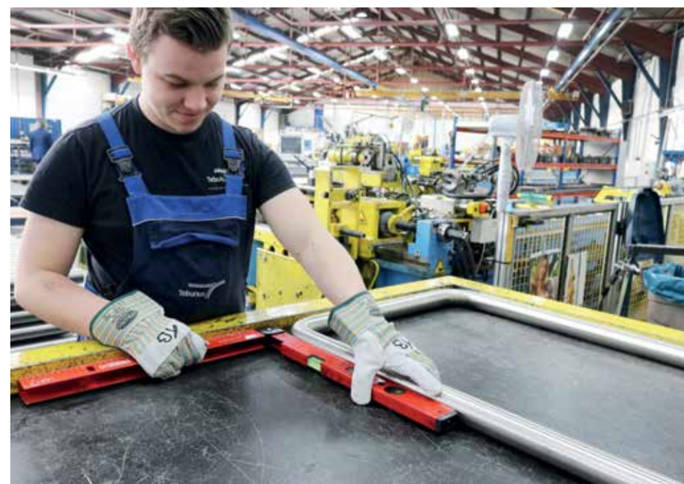
Controle van het gebogen materiaal.
